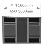
UP TO 1200mm HIGH: FOR 1 & 2 PANEL WINDOWS A MAXIMUM HEIGHT-WIDTH (PANEL) RATIO of 3:2 MUST BE ADHERED TO, WHILST THE 3 PANEL WINDOW HEIGHT-WIDTH (PANEL) RATIO IS 1:1 MAXIMUM
