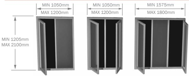
OVER 1200mm HIGH: FOR 1 & 2 PANEL WINDOWS A MAXIMUM HEIGHT-WIDTH (PANEL) RATIO of 2:1 MUST BE ADHERED TO, WHILST THE 3 PANEL WINDOW HEIGHT-WIDTH (PANEL) RATIO IS 4:3 MAXIMUM
