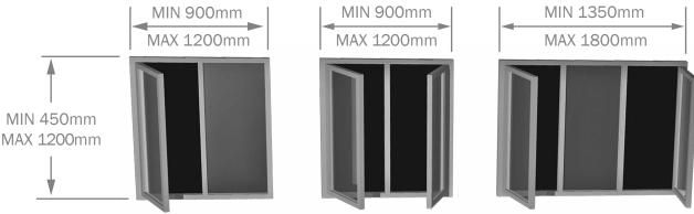
WINDOWS UP TO 1200mm HIGH: FOR 1 & 2 PANEL WINDOWS A MAXIMUM HEIGHT-WIDTH (PANEL) RATIO of 3:2 MUST BE ADHERED TO, WHILST THE 3 PANEL WINDOW HEIGHT-WIDTH (PANEL) RATIO IS 1:1 MAXIMUM
